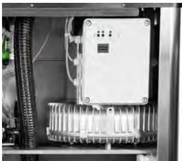
QUADRO ELETTRICO CON CONTA CICLI NON AZZERABILE ELECTRICAL PANEL WITH NON-RESETTABLE CYCLES COUNTER
