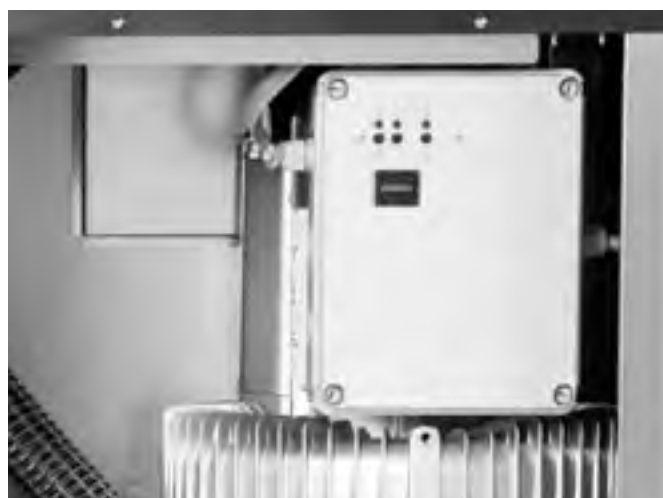
QUADRO ELETTRICO CON CONTA CICLI NON AZZERABILE ELECTRICAL PANEL WITH NON-RESETTABLE CYCLES COUNTER
