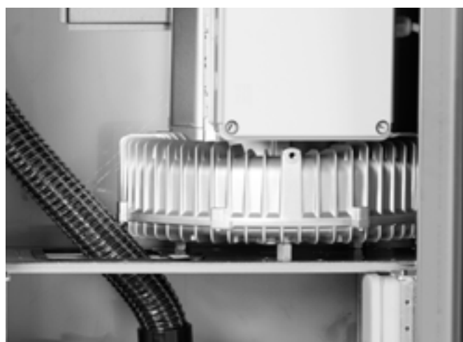
TRE MODELLI DI TURBINE DISPONIBILI TRIFASE 2,2KW 3 kW - 400 V 2,2 kW - 230 VTHREE TURBINES AVAILABLE TRIPHASE 2,2KW TRIPHASE 3KW SINGLEPHASE 2,2KW
